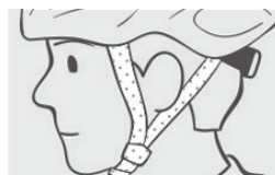
悪い例：2 アジャストロックが適切な位置でない
